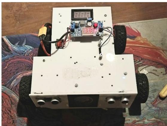
Gambar 5. Robot transporter dengan sensor ultrasonik HC-SR04
